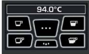
プログラムするボタンを押します (例: Key 1 (キー1)): 該当するキーのアイコンがディスプレイ上で選択されたままになります。カップに希望の量が注入されたら、キーを再度押します。コーヒーボタンの追加のプログラミングで続行します。
